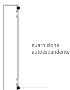
Cornice perimetrale in alluminio
