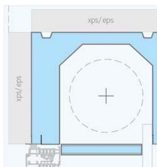
**E** Blocco di EPS di riempimento a misura da posizionare sulla sommità e/o sul fronte del cassonetto. Blocco superiore fornito sfuso.
