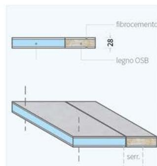
**B** Cielino termico a tampone, con una porzione fissa ed una rimovibile per ispezionare il cassonetto.
