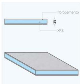
**A** Cielino termico brandeggiante (con profilo di rinforzo per  $L > 1,60$  mtl). Per la larghezza del cielino, considerare  $L$ . Arch. + 40 mm.
