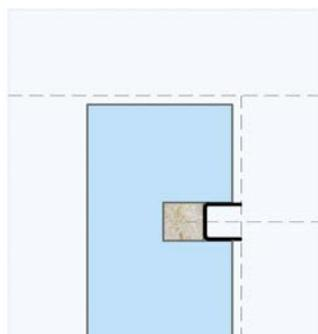
**E** Guida in lamiera (20x20 mm) predisposta per controguide in alluminio, applicata su spalle termiche in solo xps, prive di finitura in fibrocemento.
