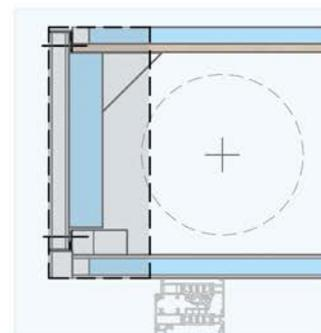
**C** Rivestimento laterale in fibrocemento per la porzione di cassonetto (Smart) aggettante all'interno della stanza.
