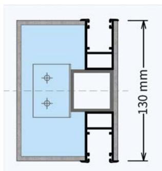
**D** Montante rompi-tratta con doppia guida per alloggiare due avvolgibili.
