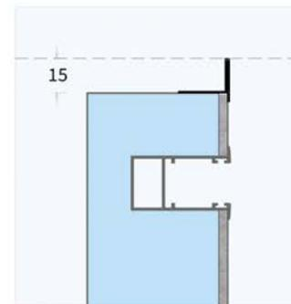
**C** Profilo paraspigolo in pvc. Idoneo per finitura muraria con intonaco esterno (con spessore di 15 mm).
