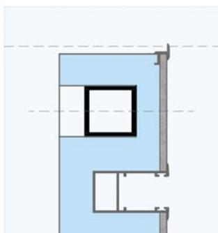
**F** Tubolare in acciaio (40x40 mm) con relative zanche a murare, integrato su spalle termiche. Funzionale al fissaggio di inferriate e/o parapetti.
