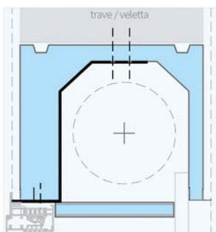
**D** Staffa di rinforzo in lamiera zincata per connettere il serramento alla struttura superiore (solo per cassonetto CSP35).
