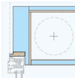
**A** Predisposizione sul cassonetto (Ecoflex) per incassare il traverso orizzontale superiore del serramento.
