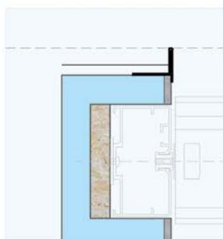
**C** Profilo paraspigolo in pvc con retina. Idoneo per finitura muraria con intonaco esterno (con spessore di 15 mm).
