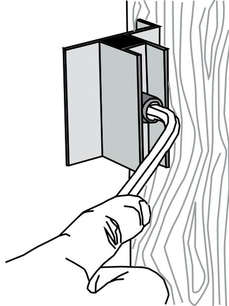
**3** Posizionamento della guida al supporto di regolazione
