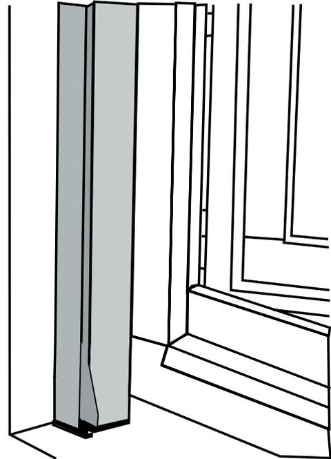
**5** LAVORAZIONE PER FISSAGGIO AL CONTROTELAIO
