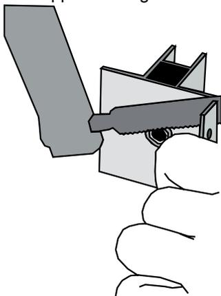
**6** LAVORAZIONE PER FISSAGGIO AL CONTROTELAIO
