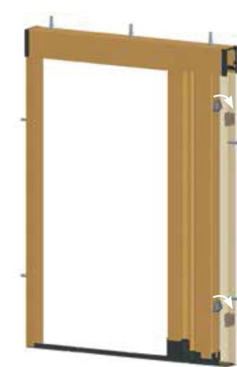
**N.B.** Per la versione due ante entrambi i profili laterali sono dotati di clip di fissaggio e al centro della guida superiore bisognerà fissare, con vite e tassello, il fermo centrale.
