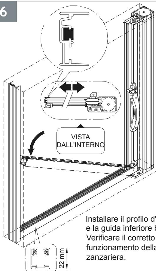
Installare il profilo d'incontro e la guida inferiore bassa. Verificare il corretto funzionamento della zanzariera.
