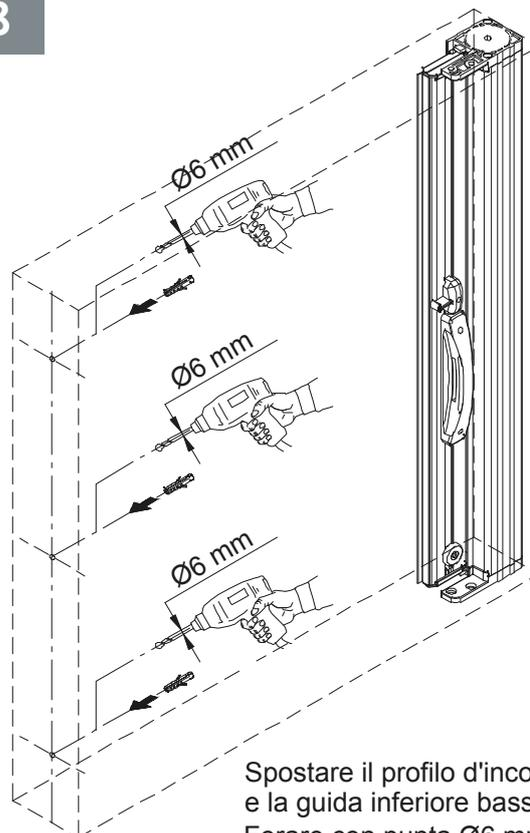
Spostare il profilo d'incontro e la guida inferiore bassa. Forare con punta Ø6 mm. Inserire i tasselli d'espansione.
