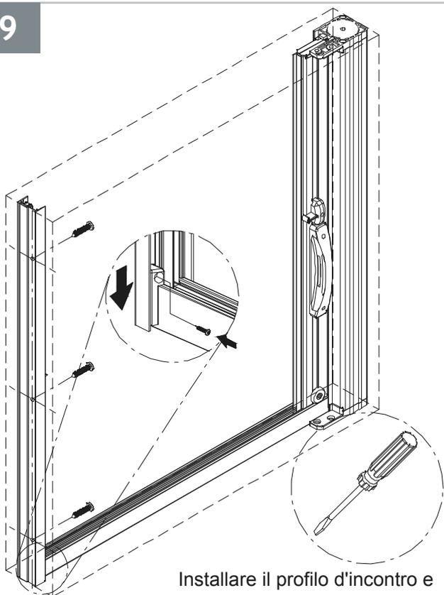
Installare il profilo d'incontro e fissare con viti. Installare la guida inferiore bassa e fissare con l'apposito fermo.
