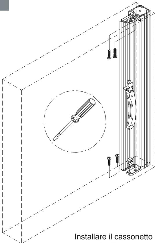
Installare il cassetto completo. Fissare con viti.
