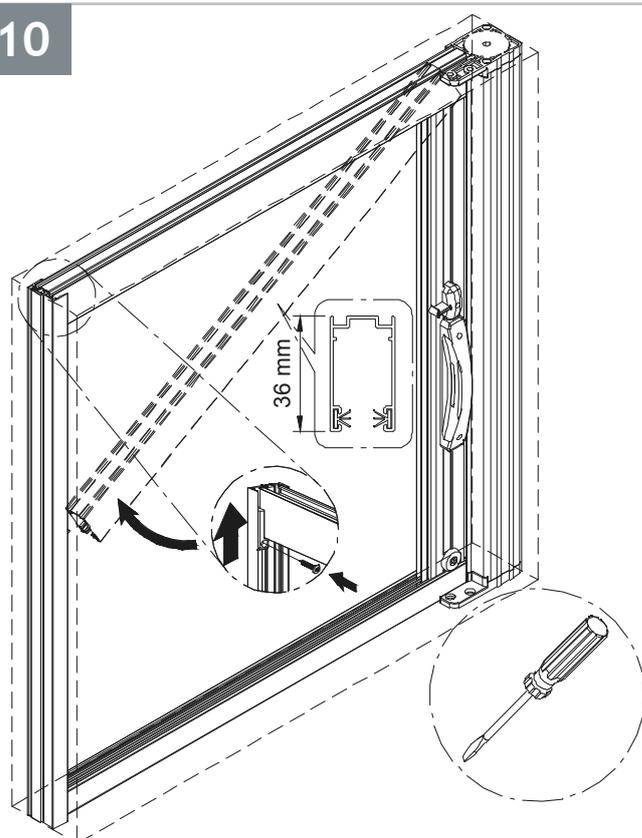
Installare la guida superiore e fissare con l'apposito fermo.
