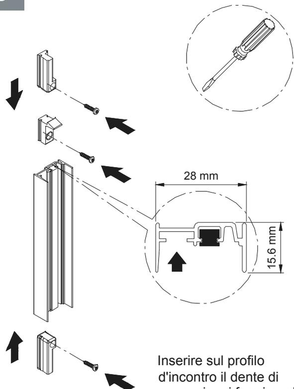
Inserire sul profilo d'incontro il dente di aggancio e i fermi per le guide. Fissare con viti.
