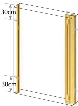
Inserire le guide negli inviti delle testate sul cassonetto e bloccarle con i fermaguida sul profilo di chiusura con viti 3,5x9,5.
