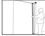
Dopo la foratura inserire i tasselli e fissare con le viti apposite gli attacchi a muro superiori.
