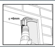
Inserire gli agganci alle guide e forare in corrispondenza del foro per consentire il bloccaggio delle guide con le viti in dotazione.
