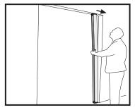
Dopo la foratura inserire i tasselli e fissare con le viti apposite l'attacco a muro superiore.
