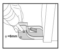
Appoggiare l'attacco a muro superiore sul cassonetto. Inserire il cassonetto nell'attacco a muro inferiore precedentemente fissato
