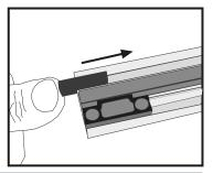
Posizionare il profilo di chiusura nel vano o p p o s t o a l c a s s o n e t t o, effettuare tre fori di fissaggio (superiore, centrale e inferiore) e fissarlo.
