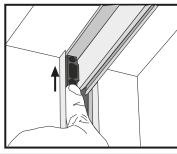
10 Fissare con la vite in dotazione il fermguida superiore.
