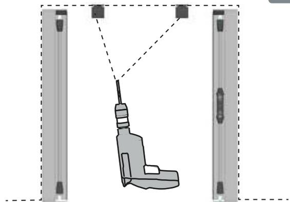
3 Prima di montare le guide, inserire un fermacricchetto nella guida inferiore e l'altro nella superiore. Infilare le guide negli inviti delle testate cassonetto. Le superiori incastrarle ai fermi guida superiori.
