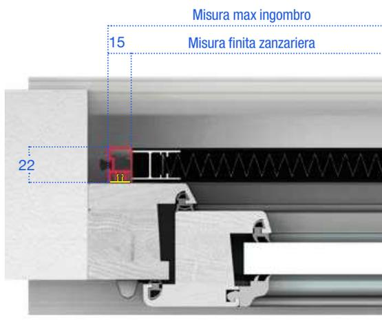
Sezione orizzontale fissaggio con vite
